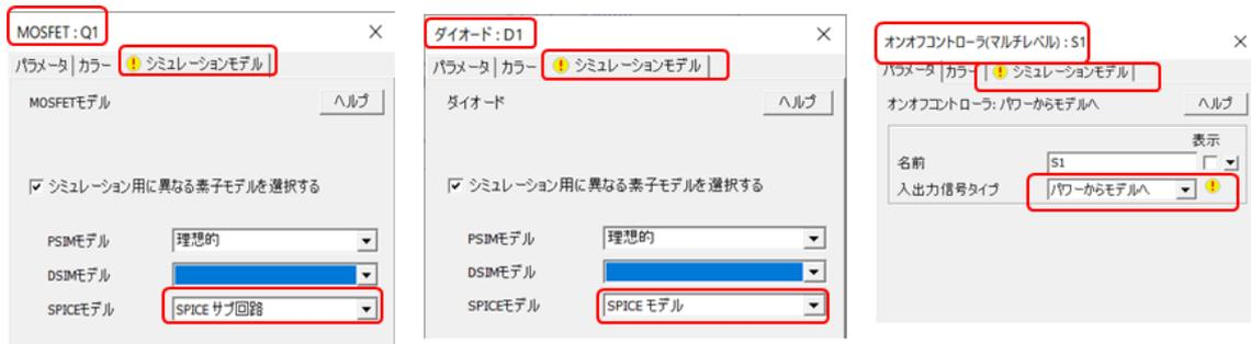
図 2-2 各素子のシミュレーションモデルの設定
