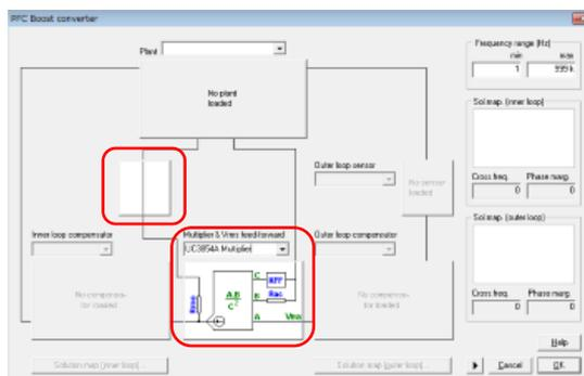
図 4-43 UC3854A マルチプライヤを選択した場合の画面（電流検出デフォルトは抵抗）
